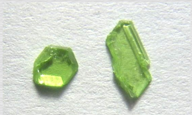
NaAl(WO 4 ) 2 Sodium aluminum tungstate. Laser crystal.
